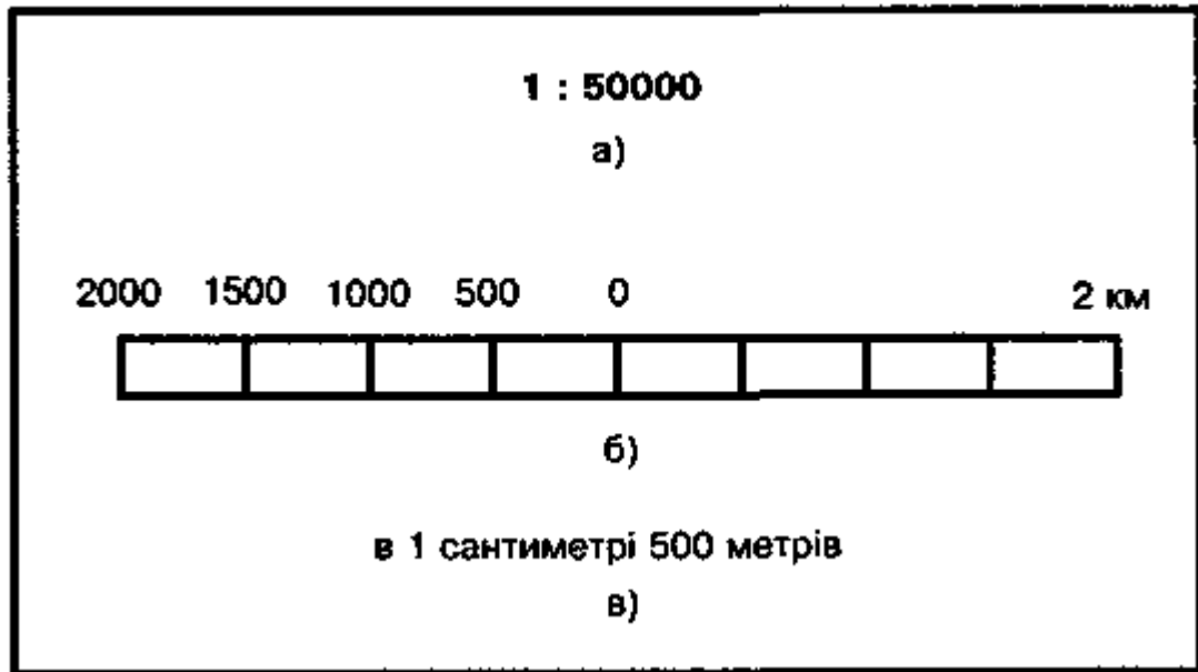
Рис. 2.6. Приклади позначення масштабу на картах: а) чисельний, б) лінійний, в) словесний.
